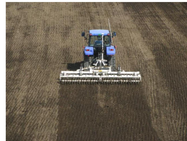
案内に従いほ場を走行させるだけで 誤差数cmで均一な平面が整備される(均平化)
