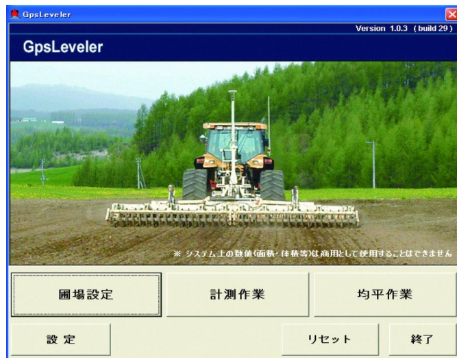
GPSレベラ (高精度GPSで高さを維持)
