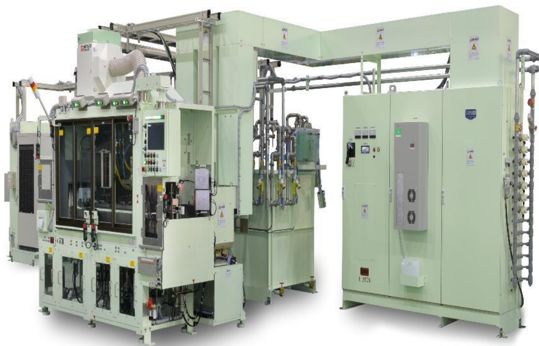
EVモーター用シャフトの焼入焼戻設備
